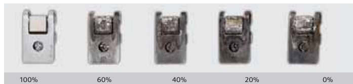
FOTO 6.2 DESGASTE DOS CONTADORES
